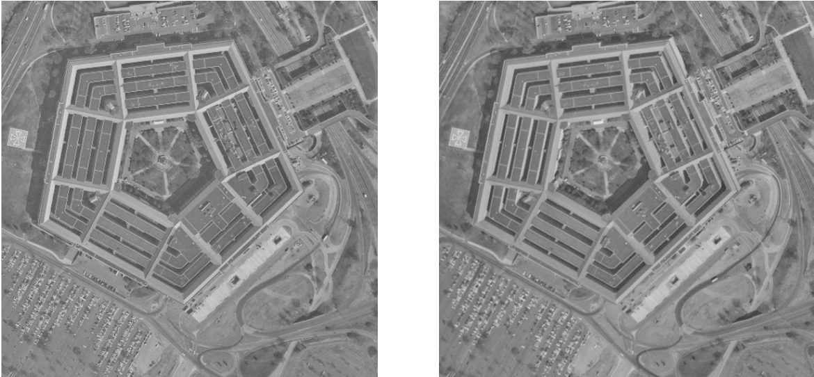
Figura 1. Par de imágenes estereoscópicas rectificadas.
