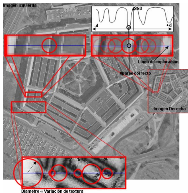
Figura 2. Par de imágenes estereoscópicas son comparadas por medio de dos ventanas, la primera centrada en el punto de interés de la primera imagen y la segunda se desplaza dentro de un rango de disparidad sobre la línea de exploración de la segunda imagen obteniendo el valor de la
